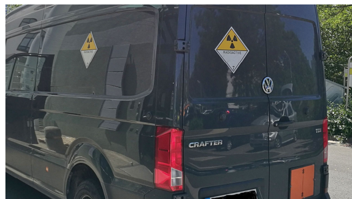
Abb. 1: Die Gefahrguttabellen kennzeichnen den Transporter für die Beförderung radioaktiver Stoffe.
