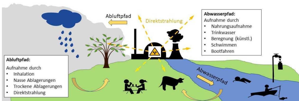
Abb.1: Wege der Strahlenexposition (Einwirkungspfade) bei kerntechnischen Anlagen
