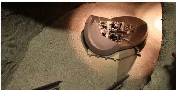
Demonstrationsversuch des Einlagerungskonzeptes für hochaktive Abfälle (Felslabor Grimsel, CH)
