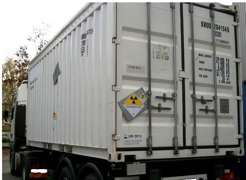
Abbildung 4 Kennzeichnung und Bezeichnung eines Containers Typ IP-2, UN 2913
