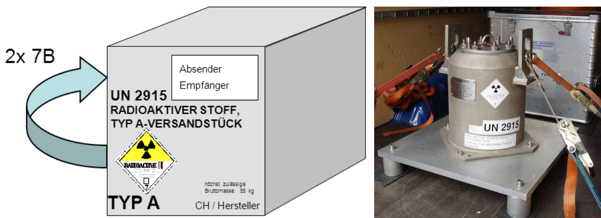
Abbildung 2 Beispiel, Kennzeichnung und Bezeichnung eines Typ A-Versandstücks, UN 2915
