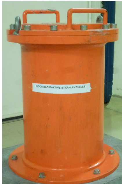
Abbildung 3 Beispiel, Kennzeichnung „hochradioaktive Strahlenquelle“
