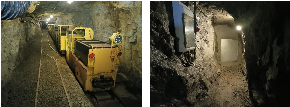
Abb. 2: Besucherstrecke im Besucherbergwerk Markus-Röhling-Stolln (links) und reparierte Wettertür in einem Stolln außerhalb der Besucherstrecke (rechts)
