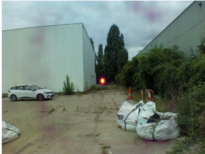
Abb. 3: Lokalisierung einer über 80m entfernten Quelle mit TBq Aktivität. Die Reduktion der Dosisleistung bei der Lokalisierung ist enorm: Wenige \mu\text{Sv/h} am Ort der Kamera und mehrere \text{mSv/h} im Nahbereich der Quelle bei Messungen mit Handdetektoren
