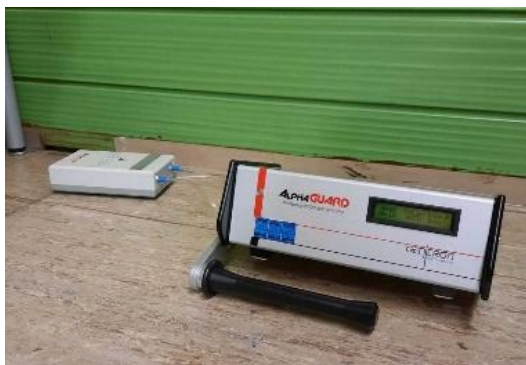
Abb. 3: Alpha-GUARD im Durchflussmodus und Lüftungsprofil
