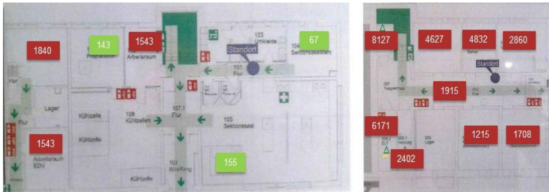
Abb. 1 – Bei der Erstmessung vom 22.06.-06.07.2020 ermittelte mittlere Radonkonzentrationen in der Prosektur Chemnitz. Links ist das Erdgeschoss dargestellt, rechts das Untergeschoss. Grün bedeutet Unterschreitung des Referenzwertes, rot bedeutet eine Überschreitung von 6 mSv bei Daueraufenthalt am Arbeitsplatz. Die Erhebung und Auswertung erfolgten durch die Firma Geoprax.
