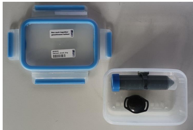
Abb. 1: Personalisierte Radonbox der LPS für die Radon-Personendosimetrie
