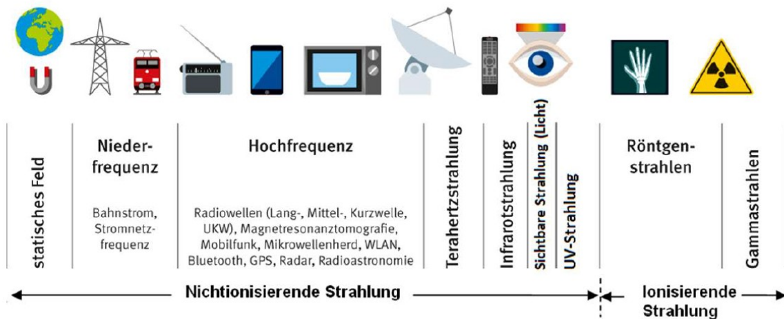
Abbildung 1.1: Elektromagnetisches Spektrum mit für die jeweiligen Frequenzbereiche typischen Quellen und Zuordnungen
