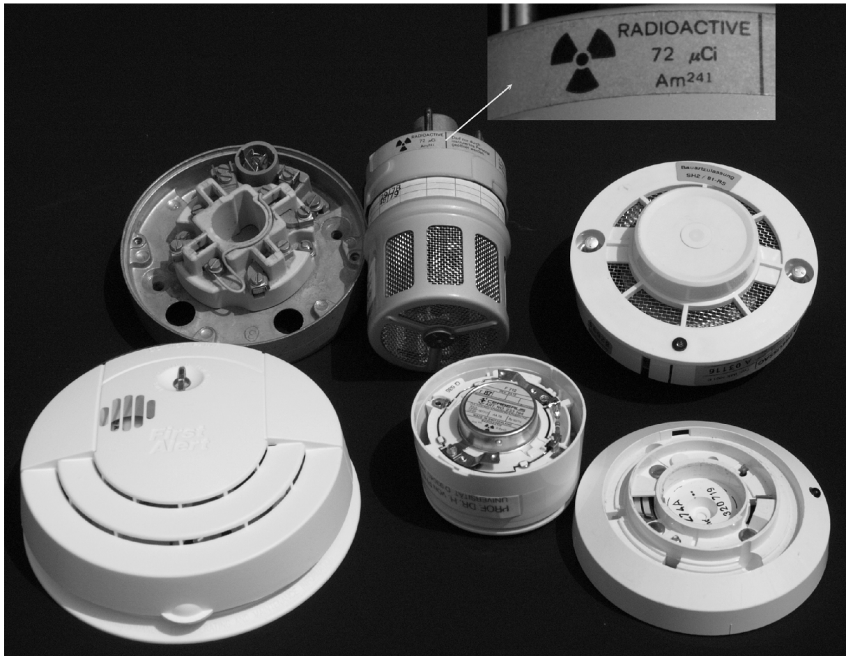
Rauchmelder: Typ Cerberus FES 5 B , wurden 1989 ausgemustert, 72 µCi Am-241, Drahtnetz Durchmesser 64 mm, Gesamthöhe 136 mm. Siehe auch StrahlenschutzPraxis 1/2001, S. 58-59. Typ CerberusF 712 , 0,8 µCi Am-241, Durchmesser oben 69 mm, Höhe 59 mm. Typ First Alert , 1 µCi Am-241, Durchmesser 136 mm, Höhe 47 mm. Typ Preussag , 0,075 µCi Am-241, Durchmesser 55/112 mm, Höhe 58 mm.
