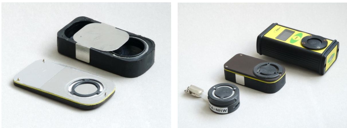
Abb. 6: Foto des ersten Funktionsmodells mit manueller Abschaltung (links) und Größenvergleich mit einem elektronischen (rechts oben) und einem etablierten Kernspur-Exposimeter (rechts unten)
