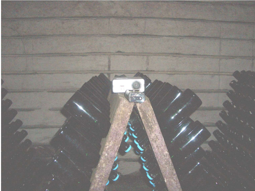
Bild 5: Messung in einem Weinkeller, gleichzeitig mit einem „Radon Scout“ und einem „DOSEman PRO“ zur Abschätzung der Dosis des Personals
