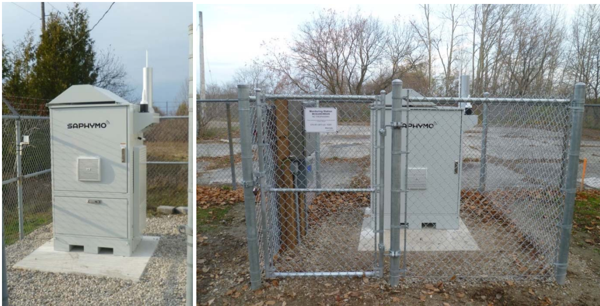
Abb. 2: Luftmonitore in Betrieb, links SA200NGS und rechts SA210ING
