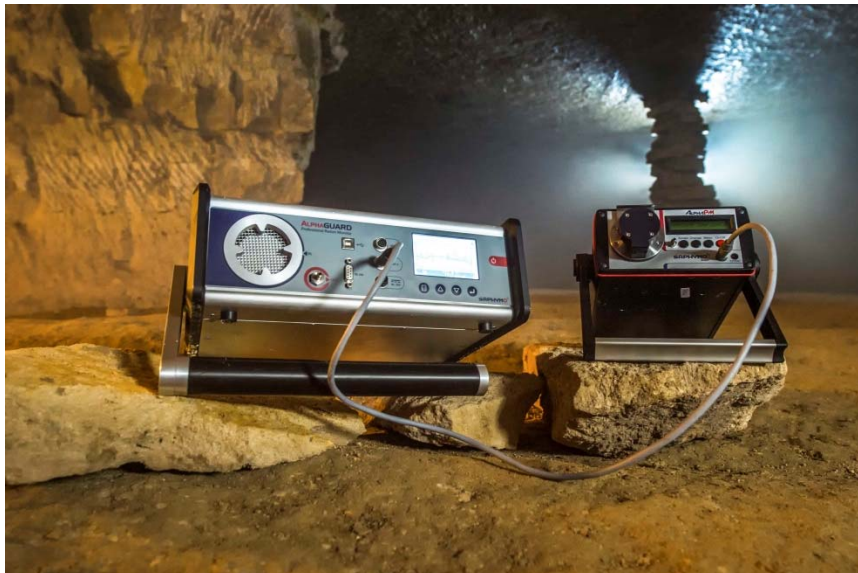
Abbildung 6: Messung von Radonfolgeprodukte mit AlphaPM
