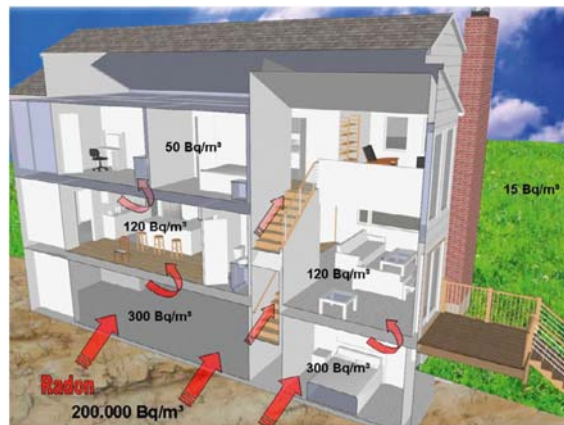
Abb.1: Schematische Verteilung der Radonkonzentration in einem Gebäude
