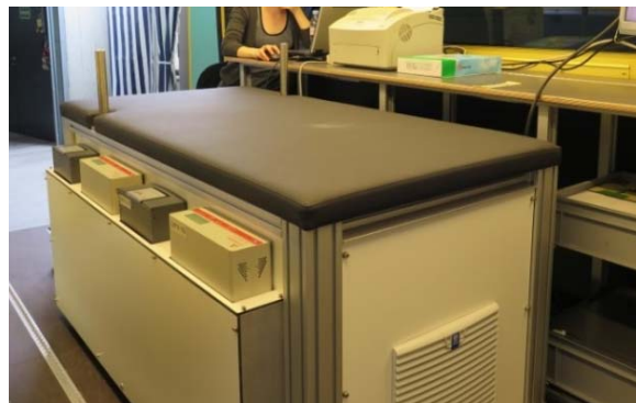
Abb. 5: Links: Schilddrüsen Messplatz. Die Person wird stehend gemessen. Rechts: Ganzkörperzähler. Die Person wird liegend gemessen.
