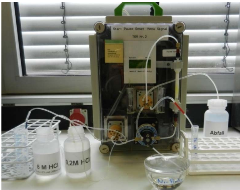
Abb.2: Trennsäulenmodul bei Fe-Trennung
