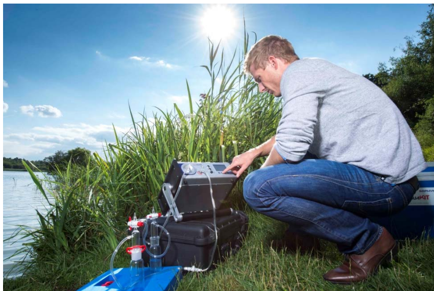
Abb. 4: Messung von Radon in Wasserproben mit AquaKIT
