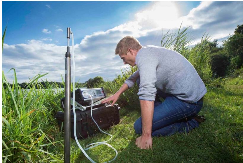
Abbildung 5: Messung von Radon in Bodenluft mit der Bodenluftsonde
