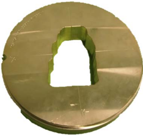
Abb. 4-1: Messingkollimator aus der Protonentherapie an der UPTD
