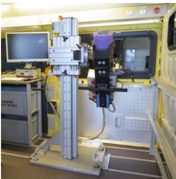
Abb. 5: Links: Schilddrüsen Messplatz. Die Person wird stehend gemessen. Rechts: Ganzkörperzähler. Die Person wird liegend gemessen.
