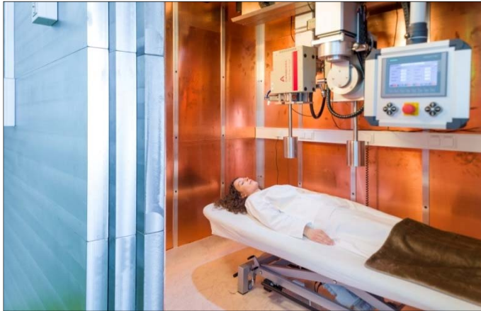
Abb. 6-1: GKZ-Messung in neuer Abschirmkammer
