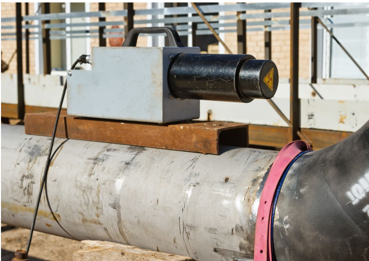
Abbildung 5: Zerörungsfreie Werkstoffprüfung – Prüfen von Schweißnähten mit einer Gamma- Strahlenquelle, Quelle: www.shutterstock.com .
