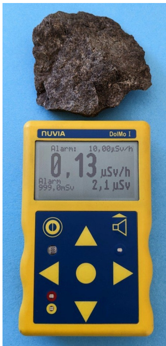
Abbildung 7: Handmessgerät für Dosisleistung im praktischen Strahlenschutz mit Gesteinsprobe
