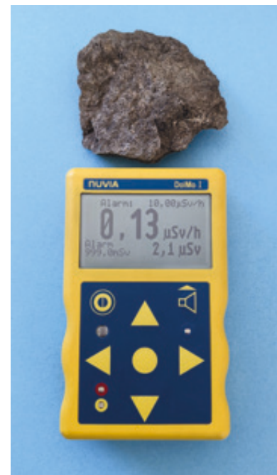
Abb. 7: Handmessgerät für Dosisleistungsmessung im praktischen Strahlenschutz mit Gesteinsprobe
