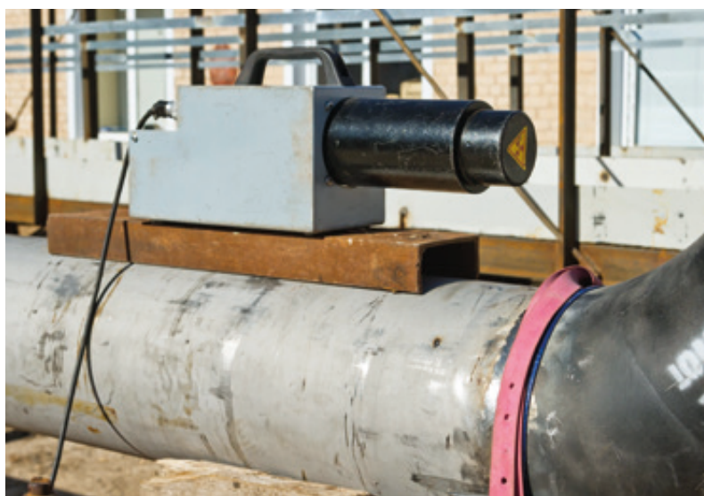
Abb. 5: Zerstörungsfreie Werkstoffprüfung – Prüfen von Schweißnähten mit einer Gamma-Strahlenquelle, Quelle: www.shutterstock.com
