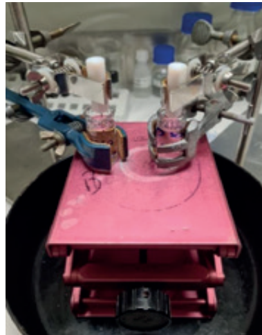
Abb. 5: Leaching einzelner Partikel in verschiedenen Flüssigkeiten
