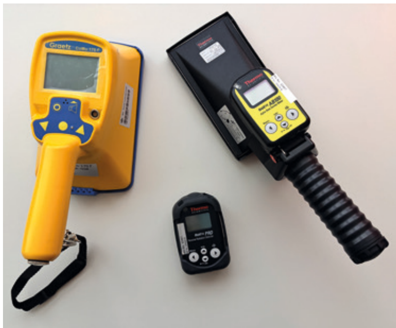
Abb. 5: Im Zentrum vorgehaltene Messinstrumente zur Detektion radioaktiver Kontamination
