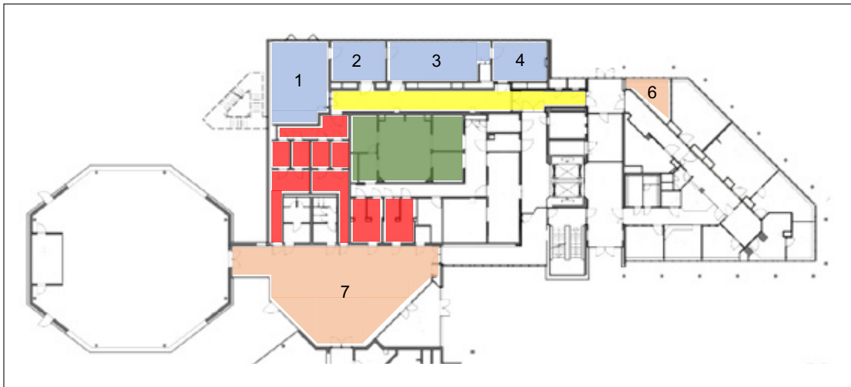
Abb. 2: Grundriss des Erdgeschosses des Zentrums für kontaminierte Verletzte mit den Bereichen Notfallbehandlung und Dekontamination (blau), OP-Trakt (grün) sowie Schleusen (rot) und Arbeitsflur (gelb)
