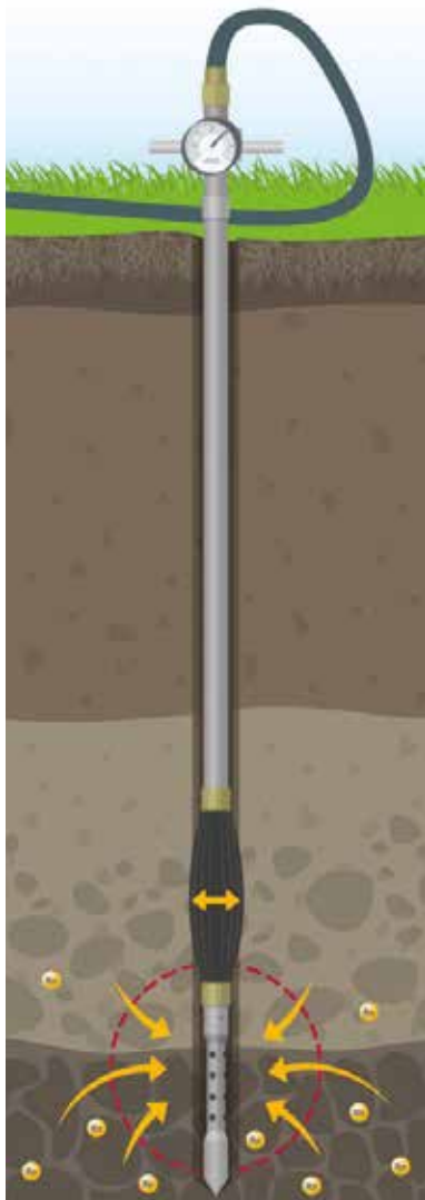
Abb. 1: Illustration einer typischen Radon-Bodenluftmessung mittels einer Packersonde; angesaugt und gemessen wird die Luft, die sich im Porenraum des Bodens in 1 m Tiefe sammelt. Grafik: conduo.de/J. Seekatz
