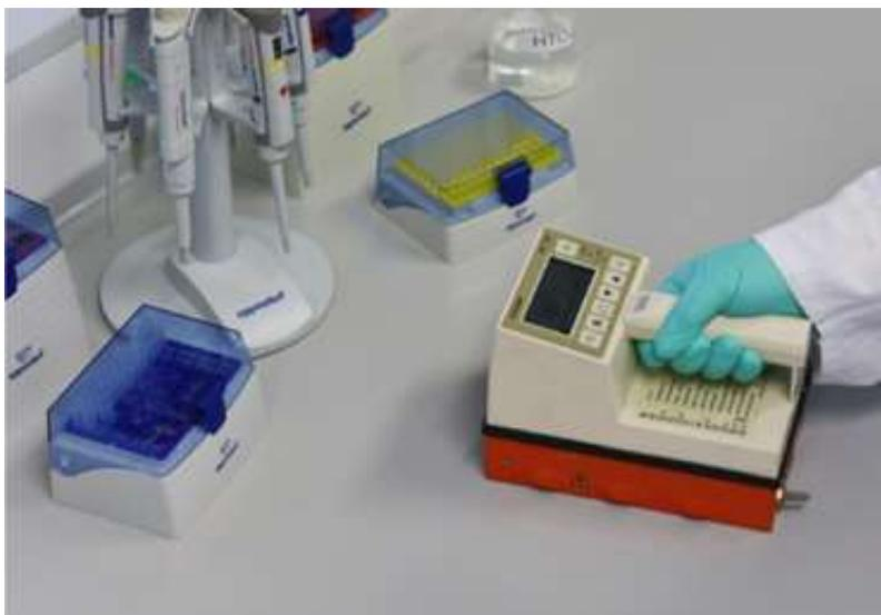
Abb. 2: Oberflächenkontaminations-Messungen mit einem speziellen Detektor für Tritium; Foto: FZJ/Andreas Holz
