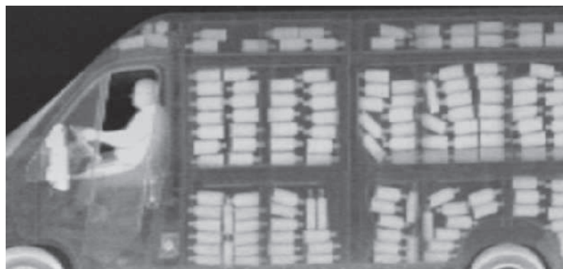
Abb. 3: Röntgenscan eines Lastwagens mit geschmuggelten alkoholischen Getränken; Foto: AS&E, www.as-e.com/resource-center/image-gallery/
