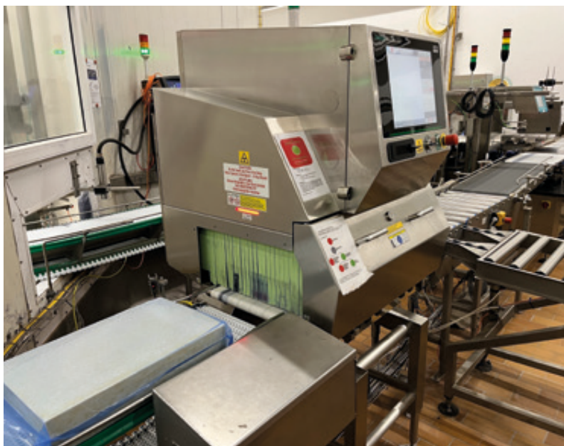
Abb. 2: Einbau einer Röntgeneinrichtung in eine Produktionslinie: Qualitätsprüfung beim Käseblock vor dem Aufschnideprozess
