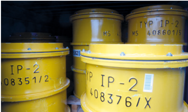
Abb. 5: 200-L-Fässer mit Schraubdeckel zum Verpacken von radioaktiven Abfällen
