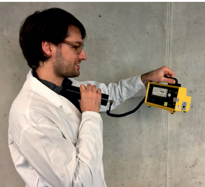
18 Triagemessung für Jod mit einem Oberflächenkontaminationsmonitor
