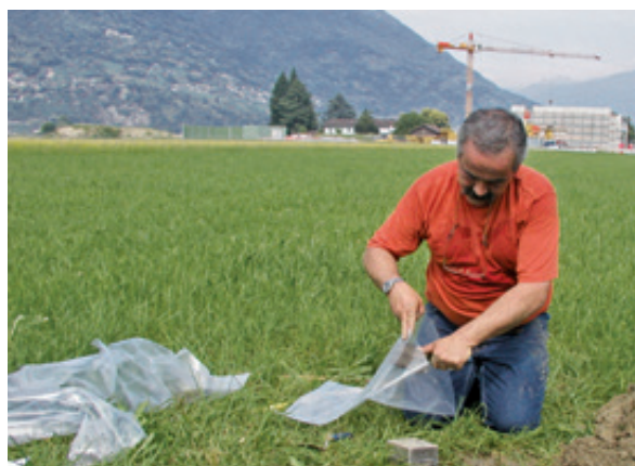
37 Vor der Analyse der Tiefenverteilung von natürlichen und künstlichen Radionukliden: Entnahme eines Bodenprofils beim Flughafen Locarno im Jahr 2005 (Stallone 2005)
