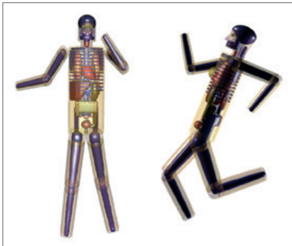
16 Simulation von Bewegungsabläufen: Beispiel für ein bewegliches Ganzkörperphantom zur Expositionsbestimmung. Es sind 2 Posen mit dem PIMAL (Phantom with Moving Arms and Legs) dargestellt.
