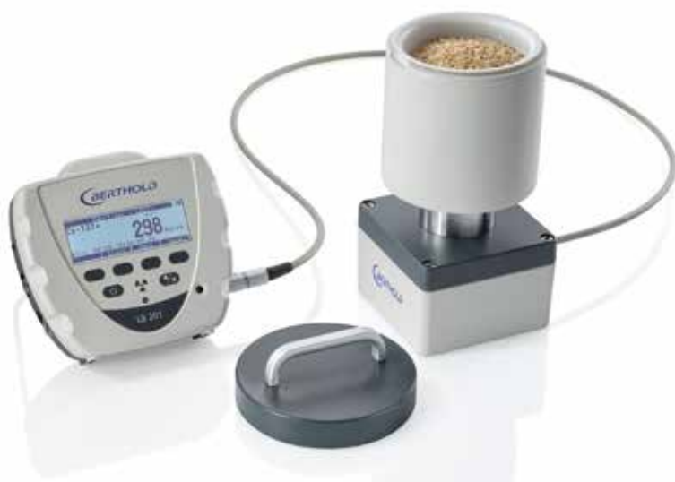
Abb. 1: Becquerel-Monitor LB 201 mit Blick in den geöffneten Marinelli-Becher mit Messgut in der Bleiabschirmung
