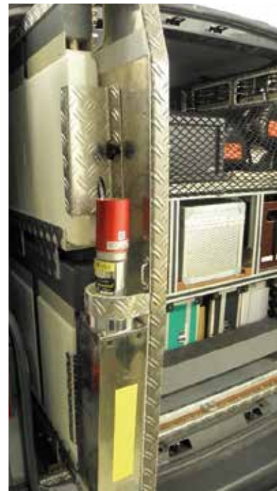
Abb. 5: Messfahrzeug des BfS mit eingebauten leistungsfähigen Detektoren
