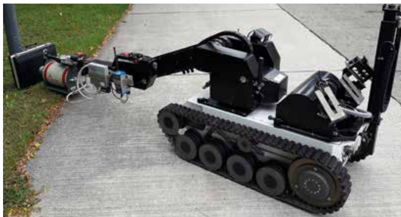
Abb. 4: BfS-Manipulator mit Gamma-Spektrometer zur ferngesteuerten Erkundung
