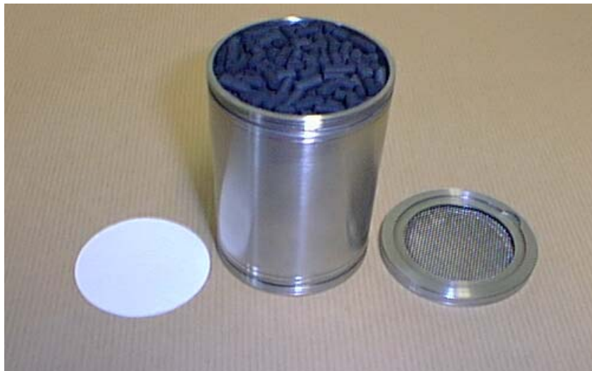
Abb.1: Iodadsorberpatrone, gefüllt mit KI-impregniertem Aktivkohlegranulat
