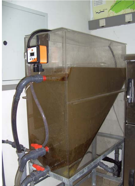
Abb. 3: Schwebstoffsammler (Absetzbecken) zur Gewinnung von Schwebstoffmischproben aus der fließenden Welle
