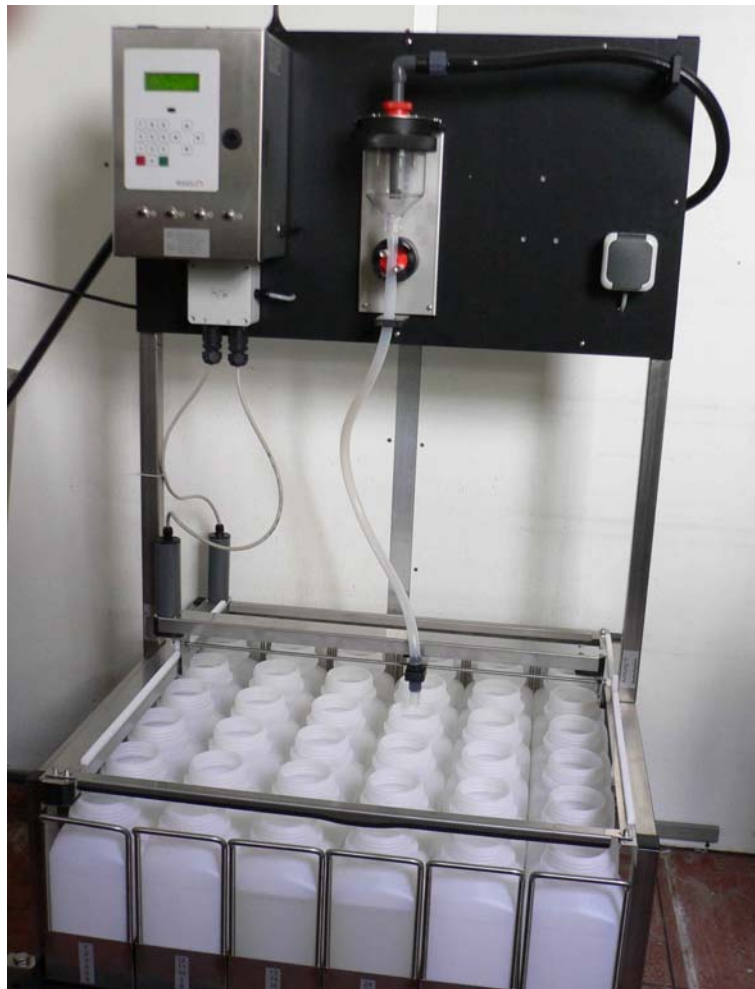
Abb. 2: Automatischer Probenentnehmer zur Entnahme von bis zu 36 Wassermischproben (Tagesproben) von je 3 L aus der fließenden Welle
