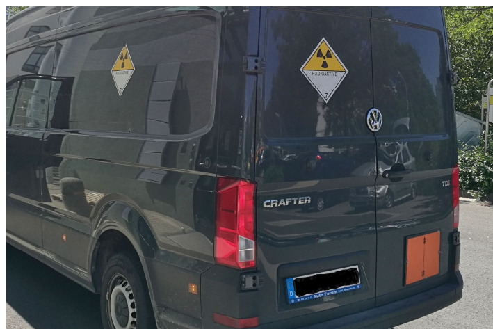
Abb. 1: Die Gefahrguttabellen kennzeichnen den Transporter für die Beförderung radioaktiver Stoffe.
